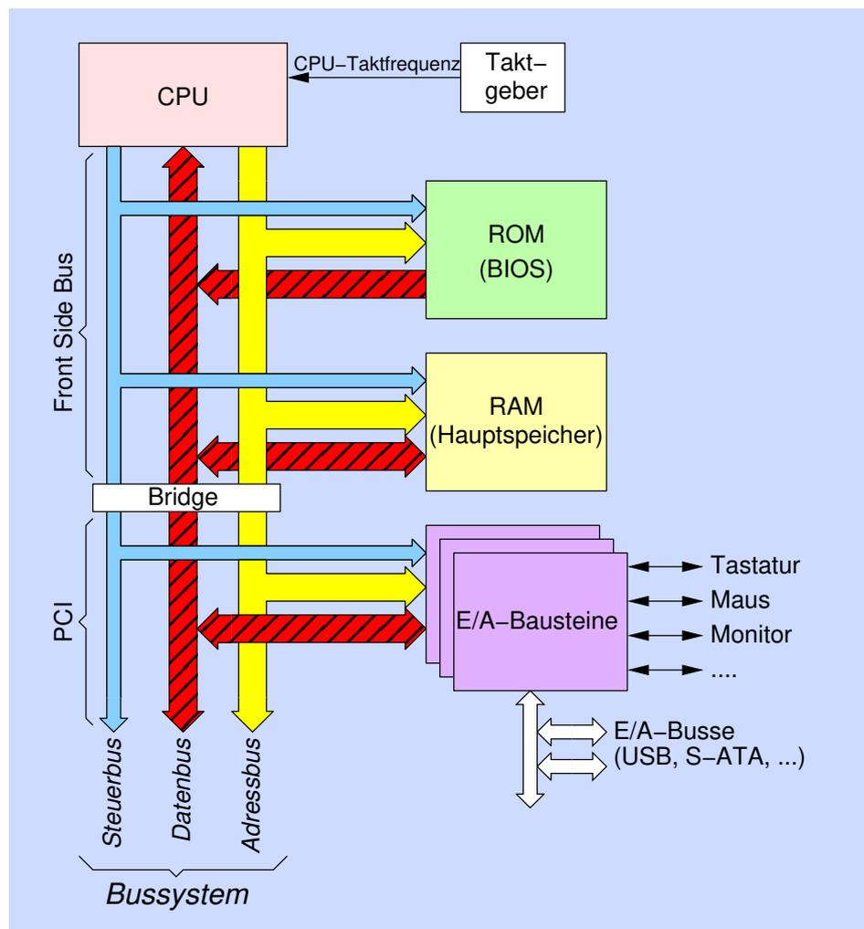
Abbildung 1: Aufbau der Zentraleinheit
