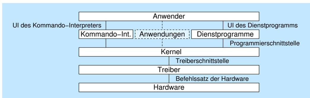
Abbildung 3: Aufbau von Linux
