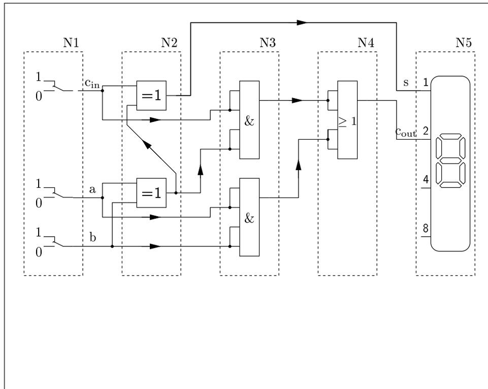
Abbildung 1: Möglicher Aufbau des Volladdierers
