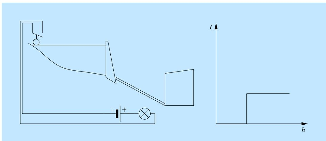
Abbildung 2: Binäre Signalübertragung
