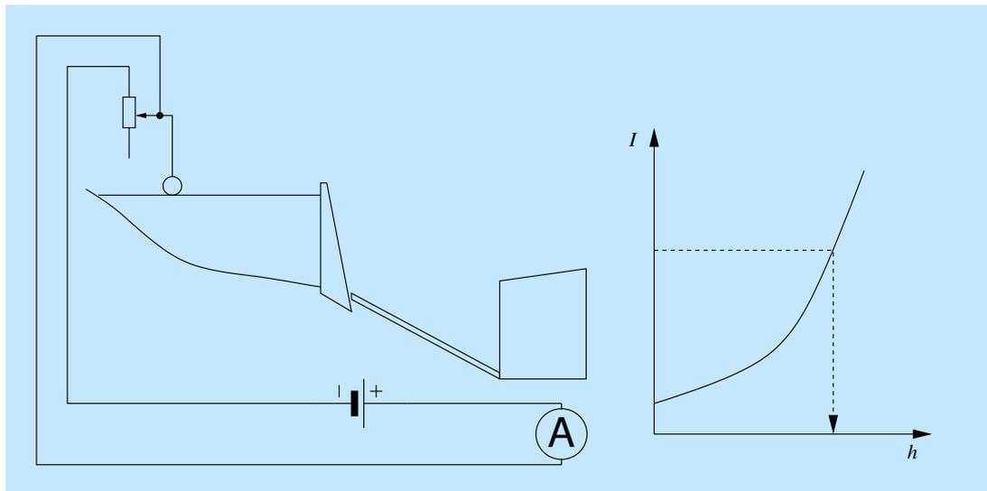
Abbildung 1: Analoge Signalübertragung
