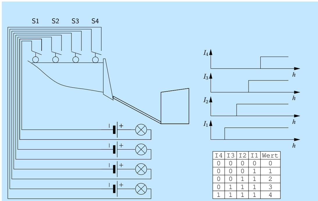
Abbildung 3: Digitale Signalübertragung
