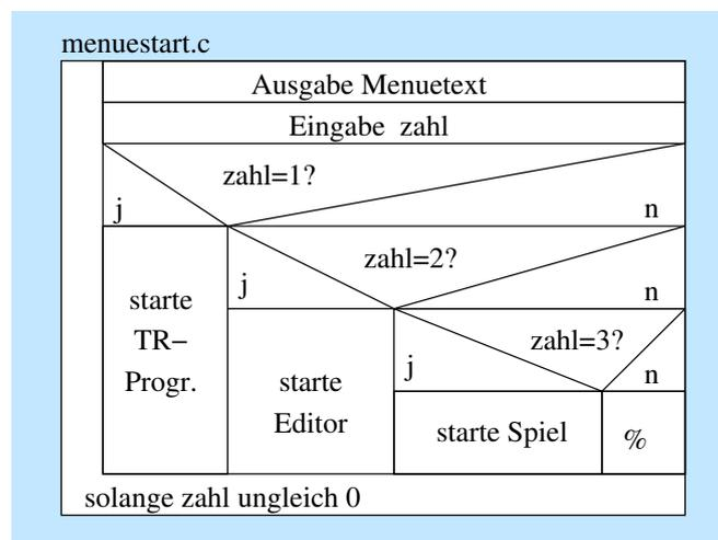
Abbildung 2: Struktogramm
