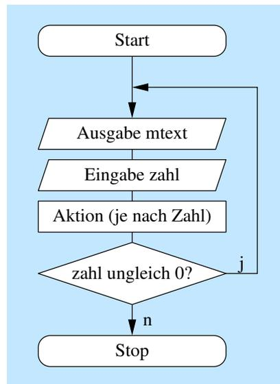
Abbildung 1: Flussdiagramm (PAP)
